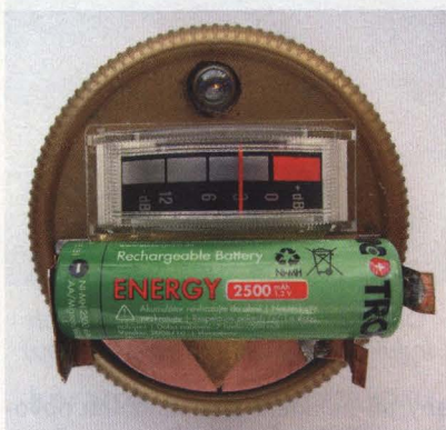
Obr. 3. Článek NiMH připojený k testeru je vybitý
