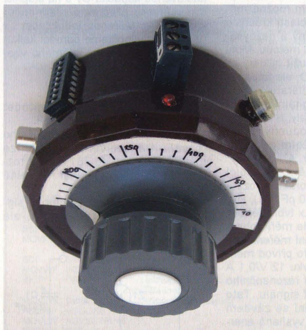
Obr. 9. Pohled na měřič malých indukčností s vlastním generátorem měřicího vf signálu
