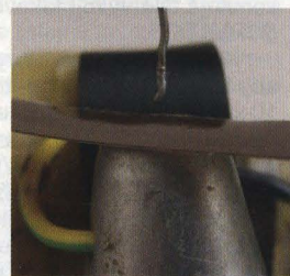
Obr. 9 a 10. Žlutá fólie (nahofe) a samolepící tapeta drží 8 kV
