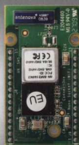
Nano Socket iWiFi™ 1.350,- Kč UART, SPI, USB WiFi: integrovaná anténa
