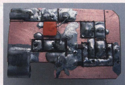
Obr. 14. Pohled na desku zkoušečky ze strany pájení
