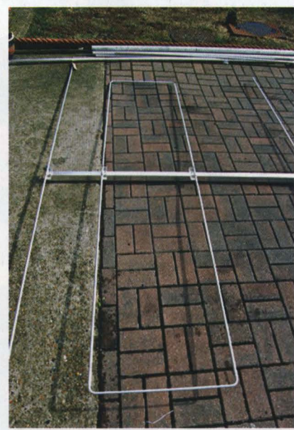
Obr. 3. Izolované upevnění prvků k nosnému ráhnu
