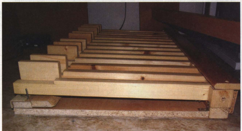
Obr. 16 a 17. Fotografie mechanické části varhaního pedálu
