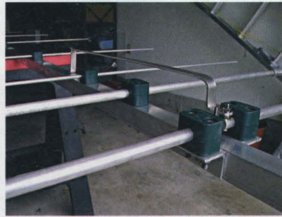
Obr. 4 a 5. Symetrizace pomocí modifikovaného Pawseyho členu
